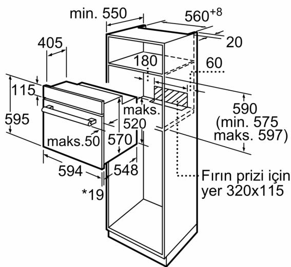
\* Metal ön cephe için 20 mm
