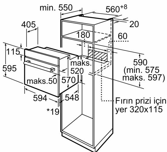
\* Metal ön cephe için 20 mm
