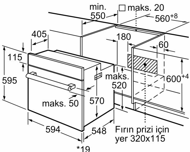
\* Metal ön cephe için 20 mm
