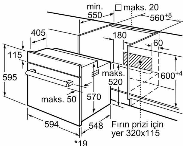
\* Metal ön cephe için 20 mm
