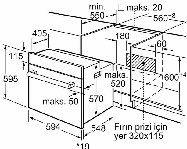
\* Metal ön cephe için 20 mm
