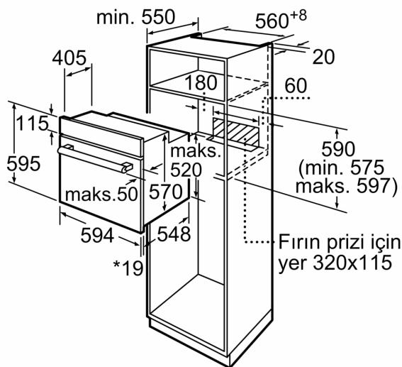
\* Metal ön cephe için 20 mm
