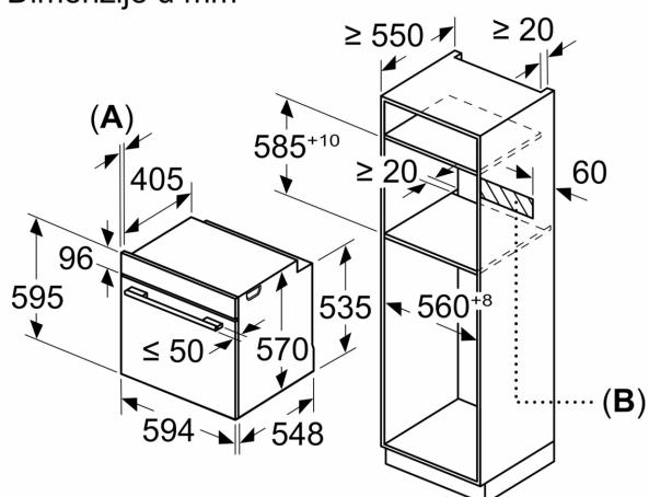
Ugradnja sa pločom za kuvanje.
