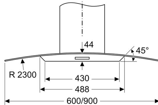
Mere za postavljanje panela za zadnji zid. Obratite pažnju na to da su mere podložne tolerancijama. Realne mere se moraj proveriti na postojećem uređaju.
