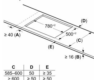
A: Min. razdalja med izrezom za kuhalno ploščo in steno
