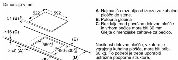
Nosičnost delovne plošče, v katero je vgrajena kuhalna plošča, mora biti pribl. 60 kg. Po potrebi je treba uporabiti ustrezne podporne strukture.
