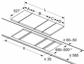
Če sta dva elementa ali več montirana tuk drug ob drugem, je potreben en montažni komplet ali več (2 elementa 1 montažni komplet, 3 elementi 2 montažna kompleta itd.)
