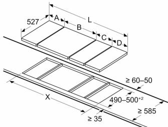
Če sta dva elementa ali več montirana tuk drug ob drugem, je potreben en montažni komplet ali več (2 elementa 1 montažni komplet, 3 elementi 2 montažna kompleta itd.)
