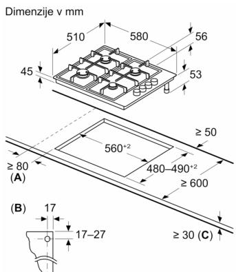
**A:** Min. razdalja med izrezom za kuhalno ploščo in steno
