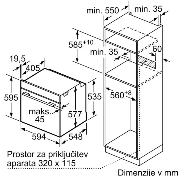
Če se aparat montira pod kuhalische, je treba upoštevati naslednjo debelino delovne plošče (po potrebi vklj. s podkonstrukcijo).
