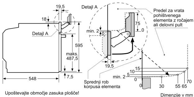
Če se aparat montira pod kuhalische, je treba upoštevati naslednjo debelino delovne plošče (po potrebi vklj. s podkonstrukcijo).
