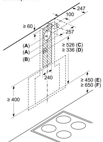
**A:** Izvodna odprtina za odzračevanje**B:** Vtičnica**C:** Komplet za recirkulacijo zraka Clean Air Plus**D:** Izhodni zrak ali standardni komplet za recirkulacijo zraka
