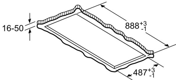
Aparata ne montirajte neposredno v mavčne kartonske plošče ali podoben lahek gradbeni material obešenega stropa. Potrebno je ustrezno nosilno ogrodje, trdno pritrjeno v betonski strop.
