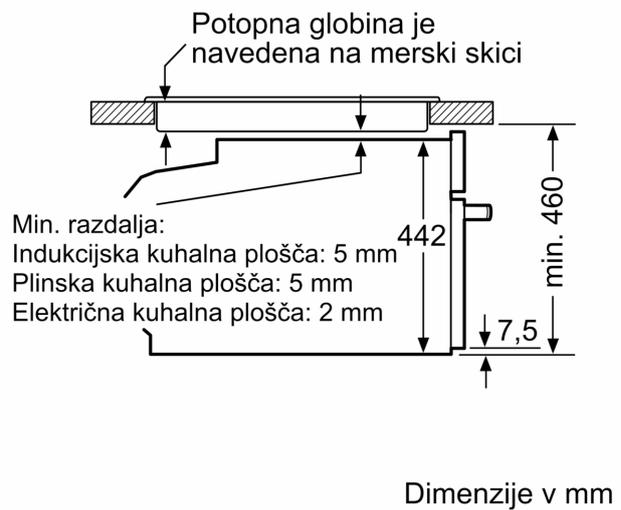
Če se kompaktni aparat montira pod kuhališče, je treba upoštevati naslednjo debelino delovne plošče (po potrebi vklj. s podkonstrukcijo).
