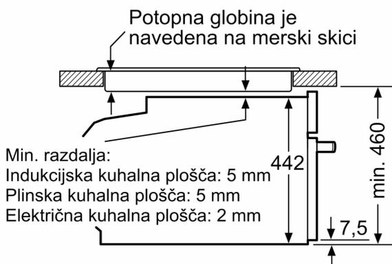
Če se kompaktni aparat montira pod kuhališče, je treba upoštevati naslednjo debelino delovne plošče (po potrebi vklj. s podkonstrukcijo).
