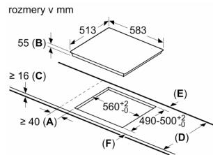
A: Minimálna vzdialenosť od výrezu na varnú dosku k stene.
