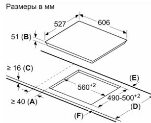
**A:** Минимальное расстояние от выреза для варочной панели до стены.
