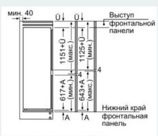
Размеры приведены с учётом зазора между дверцами 4 мм.
