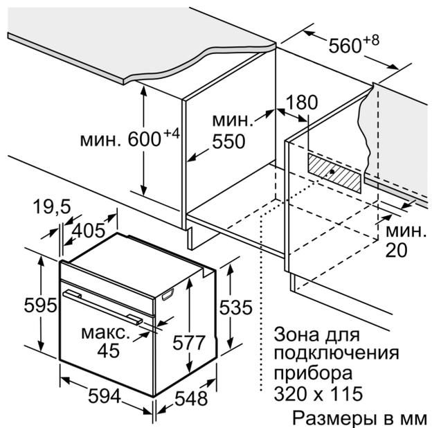
Зона для подключения прибора 320 x 115
