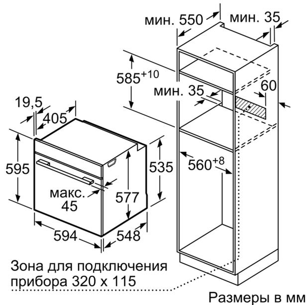
Зона для подключения прибора 320 x 115
