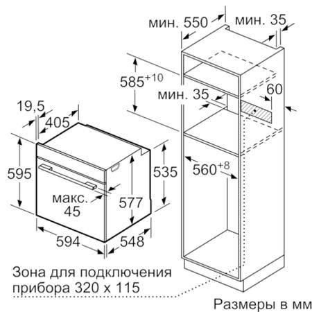
Зона для подключения прибора 320 x 115
