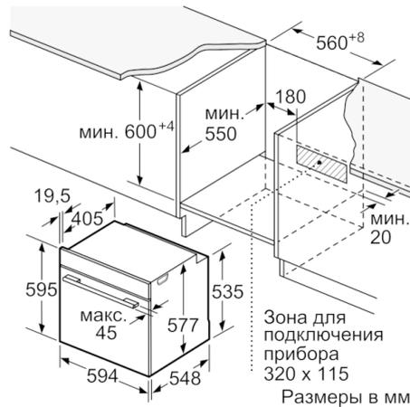
Зона для подключения прибора 320 x 115
