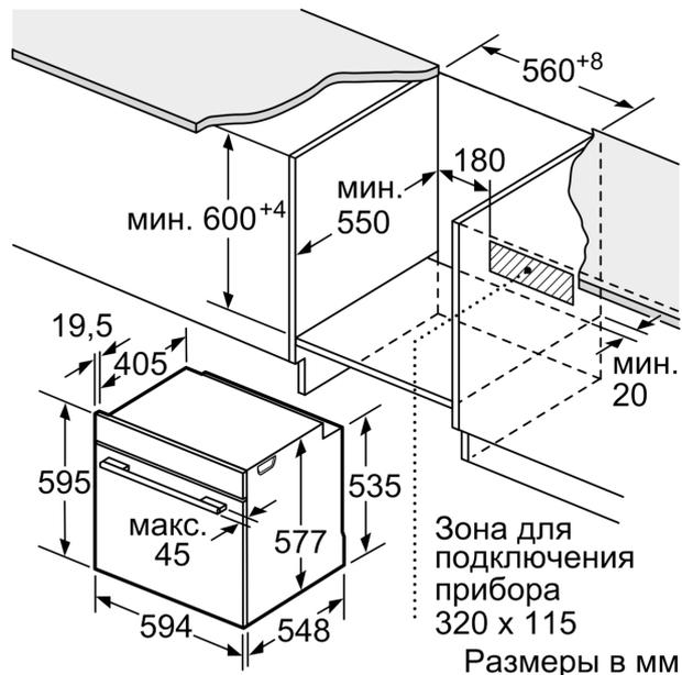
Зона для подключения прибора 320 x 115
