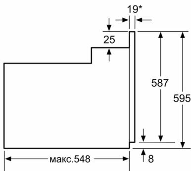
\* При металлической фронтальной панели 20 мм
