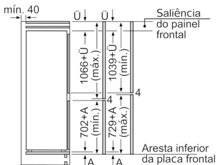
As dimensões da porta do móvel indicadas aplicam-se a uma junta de porta de 4 mm.
