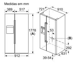
A: A parte frontal é ajustável entre 1769 e 1784B: Ligação de água ao aparelho
