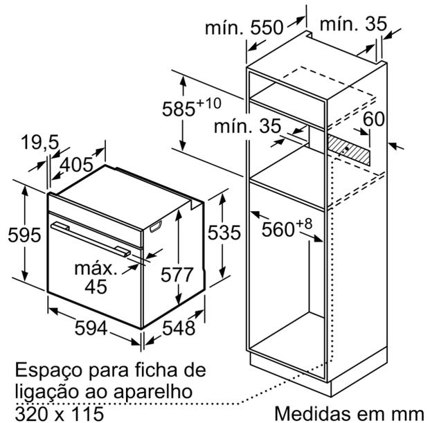
Se o aparelho for instalado por baixo de uma placa de cozinha, tem de ser observada a seguinte espessura da bancada (se necessário incl. estrutura inferior).
