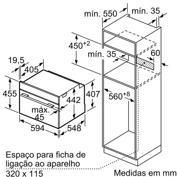
Instalação com uma placa de cozinhar.
