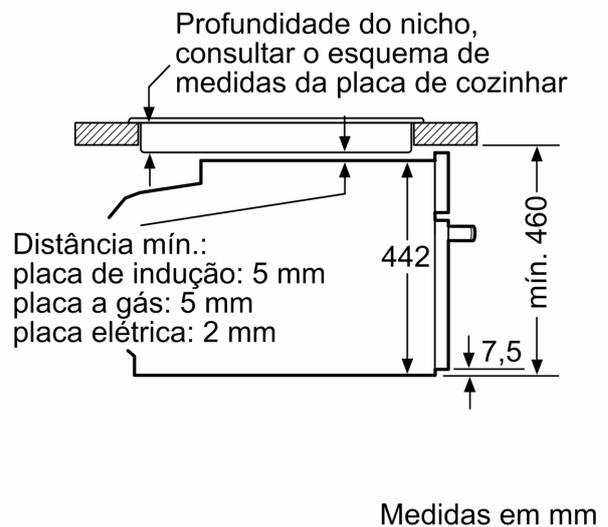
Se o aparelho compacto for instalado por baixo de uma placa de cozinhar, tem de ser observada a seguinte espessura da bancada (se necessário incl. estrutura inferior).
