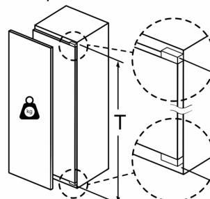
Hvis det monteres møbeldører som overskider den tillatte vekten, kan dette føre til skader og hengselet kan fungere dårligere.
