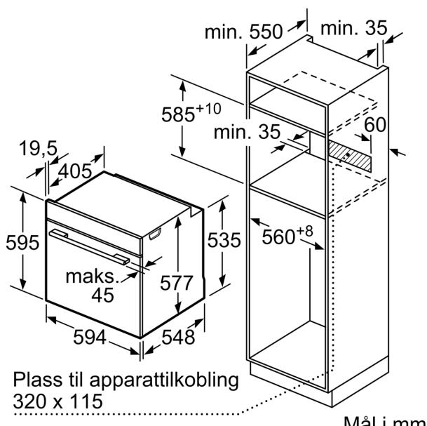
Dersom apparatet monteres under en platenopp, må benkeplate-tykkelsen (ev. inkl. underkonstruksjon) være som følger.
