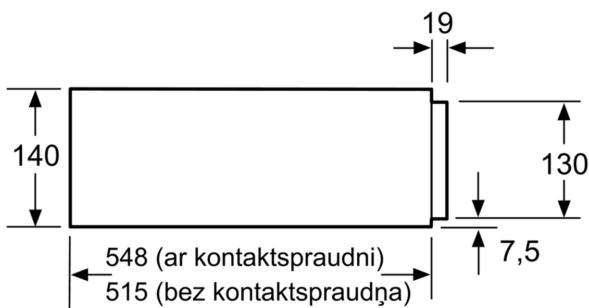
Virs sildīšanas atvilktnes var uzstādīt kompaktu cepeškrāsnī, kura ir 455 mm augsta. Starppaliktnis nav vajadzīgs.
