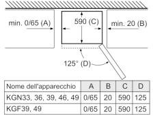
Dimensione A: nei modelli con maniglie integrate verticalmente, per aprire agevolmente è necessaria una distanza minima di 65 mm.
