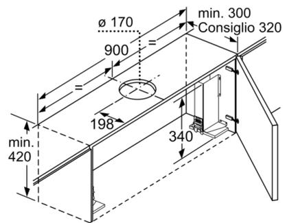
Per il montaggio della cappa piatta da 90 cm in un pensile da 90 cm è necessario un set di montaggio. Entrambi gli angolari di montaggio vengono avvitati a sinistra e a destra nel mobile. Montaggio in base alla mascherina.
