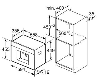
Il serbatoio dell'acqua e quello dei chicchi di caffè vengono estratti in avanti. Altezza di montaggio consigliata 95-145 cm. Dimensioni in mm
