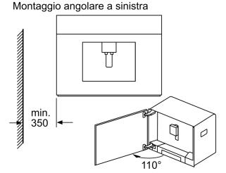
utilizzando una limitazione della cerniera di 92° (cod. pezzo di ricambio 00636455) la distanza minima alla parete è di soli 100 mm. Dimensioni in mm
