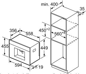
Il serbatoio dell'acqua e quello dei chicchi di caffè vengono estratti in avanti. Altezza di montaggio consigliata 95-145 cm. Dimensioni in mm
