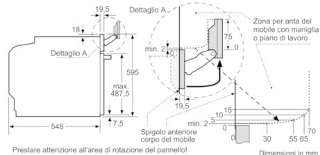
Se l'apparecchio viene montato sotto un piano di cottura deve essere rispettato il seguente spessore del piano di lavoro (event. incl. sottostruktur).
