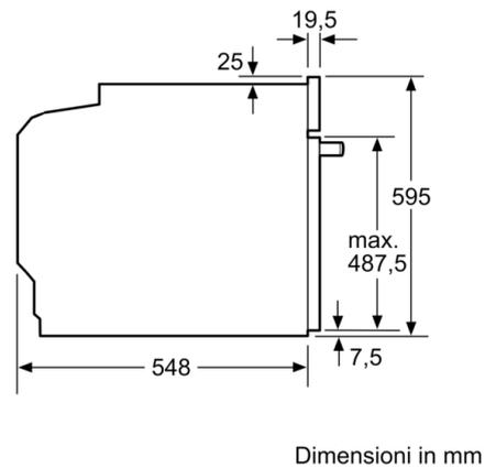
Montaggio con un piano di cottura.
