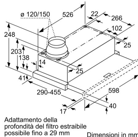
Adattamento della profondità del filtro estraibile possibile fino a 29 mm Dimensioni in mm
