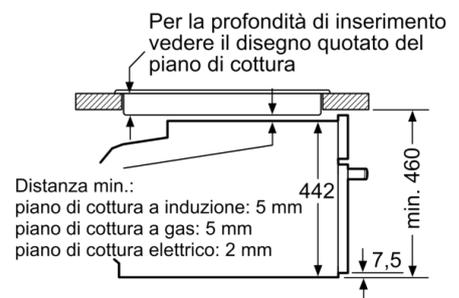
Se l'apparecchio compatto viene montato sotto un piano di cottura deve essere rispettato il seguente spessore del piano di lavoro (event. incl. sottostruttura).
