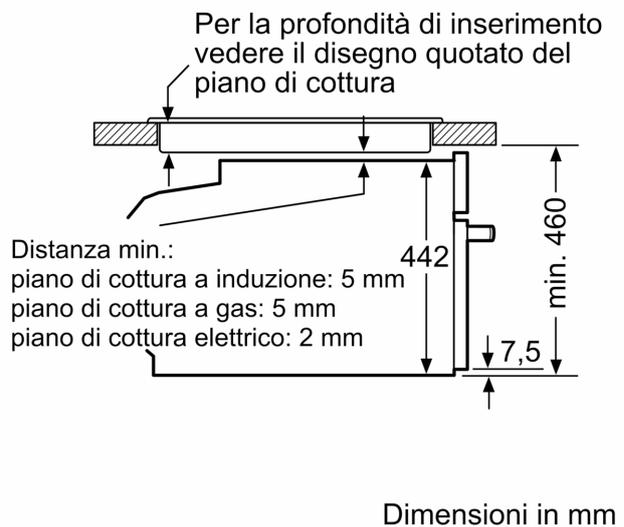
Se l'apparecchio compatto viene montato sotto un piano di cottura deve essere rispettato il seguente spessore del piano di lavoro (event. incl. sottostruttura).
