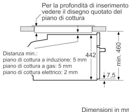
Se l'apparecchio compatto viene montato sotto un piano di cottura deve essere rispettato il seguente spessore del piano di lavoro (event. incl. sottostruzione).
