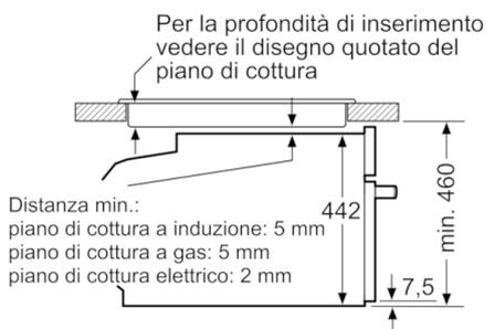
Se l'apparecchio compatto viene montato sotto un piano di cottura deve essere rispettato il seguente spessore del piano di lavoro (event. incl. sottostruttura).
