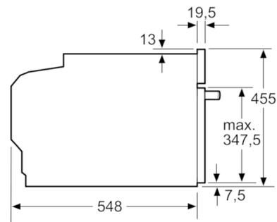
Montaggio con un piano di cottura.
