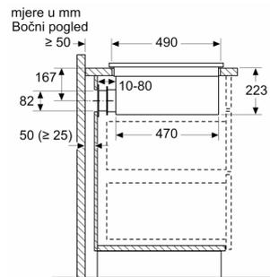
Prilikom izravne ugradnje uz vanjske zidove bez izolacije ( $\mu \geq 0,5 \text{ W/m}^2 \cdot \text{°C}$ ), preporučujemo upotrebu konfiguracija za recirkulaciju s djelomično ili potpuno provedenim cijevima.
