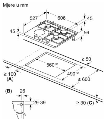
**A:** Min. udaljenost od otvora za ploču za kuhanje do zida
