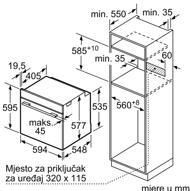
Ukoliko se uređaj ugradi ispod ploče za kuhanje, tada treba poštivati slijedeće debljine radnih ploča (ukoliko je potrebno uključujući i podkonstrukciju).
