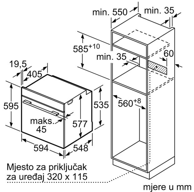
Ukoliko se uređaj ugradi ispod ploče za kuhanje, tada treba poštivati slijedeće debljine radnih ploča (ukoliko je potrebno uključujući i podkonstrukcija).
