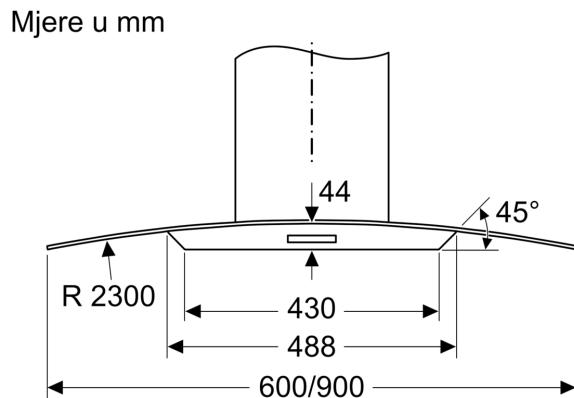
Mjere za dimenzioniranje panela stražnjeg zida. Uzmite u obzir da sve mjere podlježe odstupanjima. Stvarne mjere moraju se provjeriti na postojećem uređaju.
