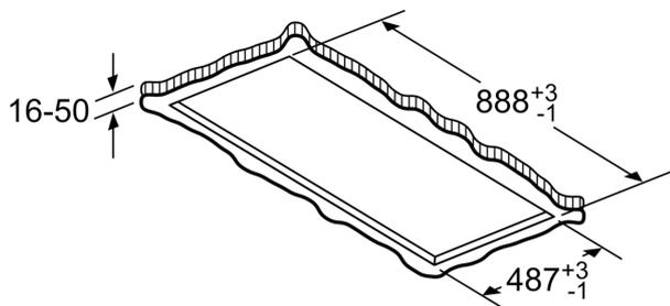
Ne montirajte direktno na gips kartonske ploče ili slične lake građevinske materijale spušenog stropa. Potrebna je odgovarajuća podkonstrukcija koja je čvrsto fiksirana u betonskom stropu.
