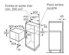
\* 20 mm pour la façade métallique Mesures en mm
