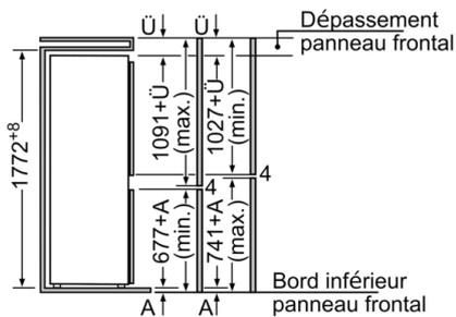
Les mesures de la porte du meuble indiquées sont valables pour un joint de porte de 4 mm. Pour toute autre largeur de joint (max. 14 mm), il faut adapter les mesures. Pour de plus grandes mesures (1780-1790), une baguette d'écartement doit être appliquée au plafond de la niche.
