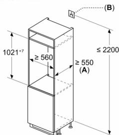
A:  $\geq 560 \text{ mm}$  (recommandé)
